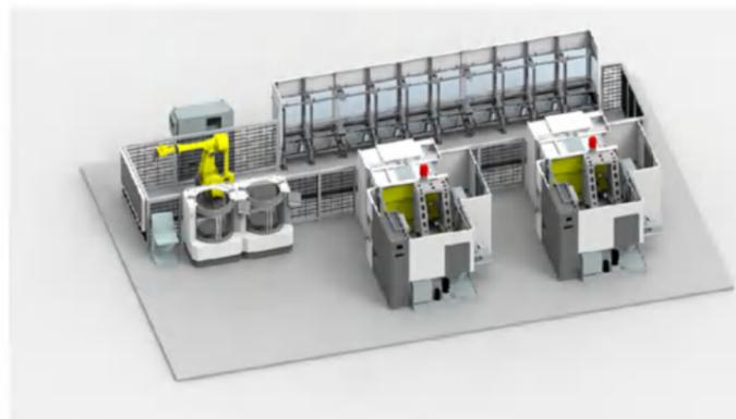
FMS50是新一代模块化柔性制造系统，由多台TH6350III卧式加工中心、1条有轨搬运机器人、20个工位托板库、2个上(下)料工位及总控系统组成，可随加工。对象不同对机床及库位进行扩展。主要适用于减速器、泵阀体、工业缝纫机、五金工具等各种类型的复杂零件加工。
